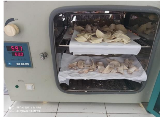
Gambar 10. Pengeringan Talas garam untuk mengurangi kadar oksalat
